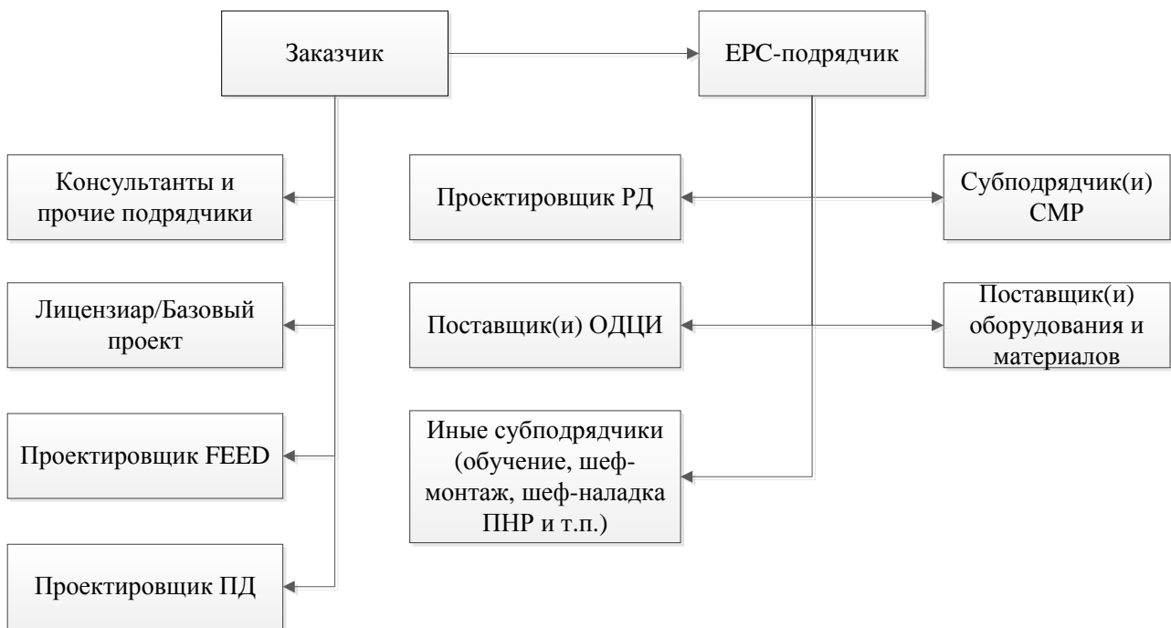
Рисунок 1 - Типичная контрактная стратегия реализации крупного строительного проекта с использованием интегрированного контракта ЕРС
